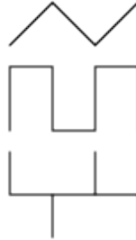
Figure 2.26: Signal carré, intégré et différentié.
